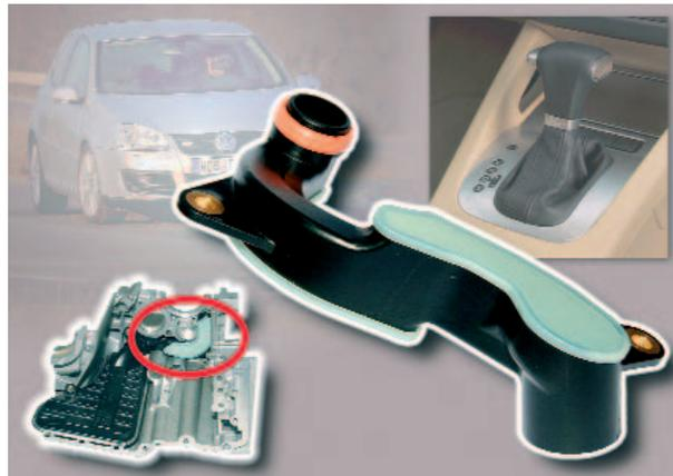
En la caja de cambios con embrague dual de algunos modelos VW Golf, Jetta, Touran y Passat, aceite a más de 140°C de temperatura pasa por un manguito de formas complejas de nylon Zytel® de DuPont. IBS Filtran, de Morsbach, cerca de Colonia (Alemania) moldea por inyección el manguito en tres piezas que son luego soldadas por láser.
