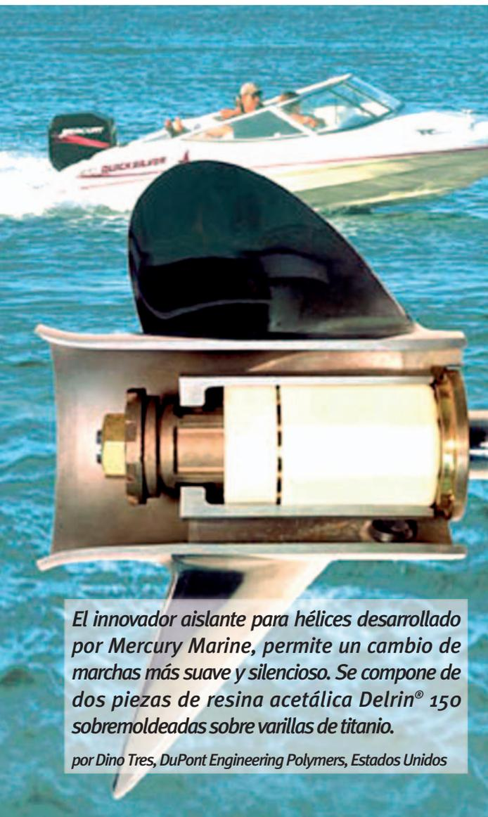
**El innovador aislante para hélices desarrollado por Mercury Marine, permite un cambio de marchas más suave y silencioso. Se compone de dos piezas de resina acetálica Delrin® 150 sobremoldeadas sobre varillas de titanio.**
