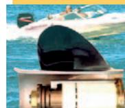
**Un aislante de hélice suaviza el cambio de marcha** El innovador aislante para hélices desarrollado por Mercury Marine, permite un cambio de marchas más suave y silencioso. Se compone de dos piezas de resina acetálica Delrin® 150 sobremoldeadas sobre varillas de titanio.
