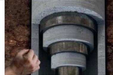
TODO ELLO, A PESAR DEL TRIPLE ENCAPSULADO DEL TUBO DE PERFORACIÓN HASTA POR DEBAJO DEL ACUÍFERO
