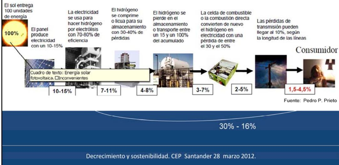
El hidrógeno no es una fuente de energía, sino un acumulador. Podemos utilizar energía eléctrica (solar, por ejemplo) para conseguir hidrógeno por hidrólisis y luego juntar el hidrógeno con oxígeno de nuevo y recuperar la energía. El problema es que el rendimiento de todo el proceso, de momento, no es muy elevado. Se pierde mucha energía en el transporte y compresión del hidrógeno y las pilas de combustible para “quemar” el hidrógeno siguen siendo caras.
